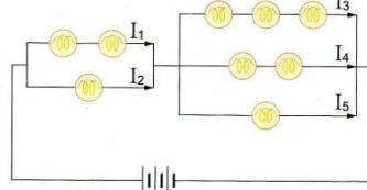
49. 右圖的電路中， $I_1=22\text{ A}$ ， $I_2=44\text{ A}$ ， $I_3=12\text{ A}$ ， $I_4=18\text{ A}$ ，則下列何者正確？
