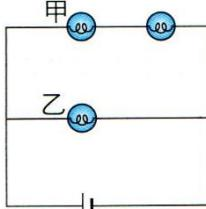
51. 甲、乙兩燈泡並聯在同一電路中，如右圖，若流過電池的電流有 20 安培，流過甲燈泡的電流有 8 安培；則流過乙燈泡的電流為多少安培？
