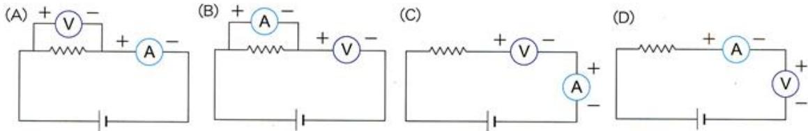
35. 使用安培計及伏特計正確的量出經過電燈的電流與電池的電壓，其連接的線路圖為下列何者？
