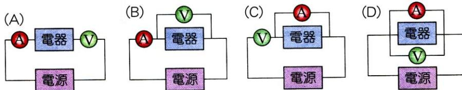
28. 測量電流的大小時，安培計與欲測的線路該如何連接？
