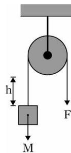
(A) 定滑輪是省力的機械 (B) 使用定滑輪可改變施力的方向 (C) 改用半徑越大的定滑輪，則會越省力 (D) 施力所作的功小於物體重力位能的增加量。
