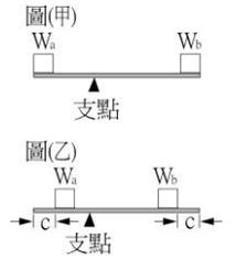
12. 有一水平木棒長度未知、重量不計，彬彬以距左端 10cm 處為支點時，左端向上施力 20N、右端向上施力 10N 可達到平衡，則此棒長度為多少公分？
